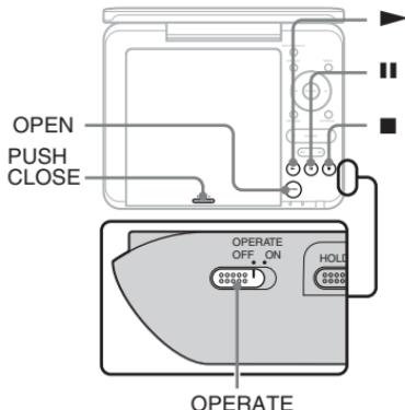
**1 Otvorite LCD ekran.****2 Preklopku OPERATE postavite u položaj "ON".**
