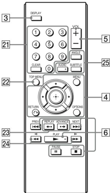
Tipke VOL +, 5, ► i AUDIO imaju ispuštanje. Ispuštanje služi kao referentna tačka tokom upotrebe uređaja.
