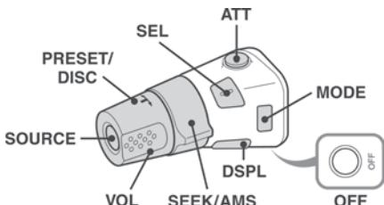
Sljedeće kontrole na zakretnom upravljaču zahtjevaju različite radnje od onih na uređaju.
