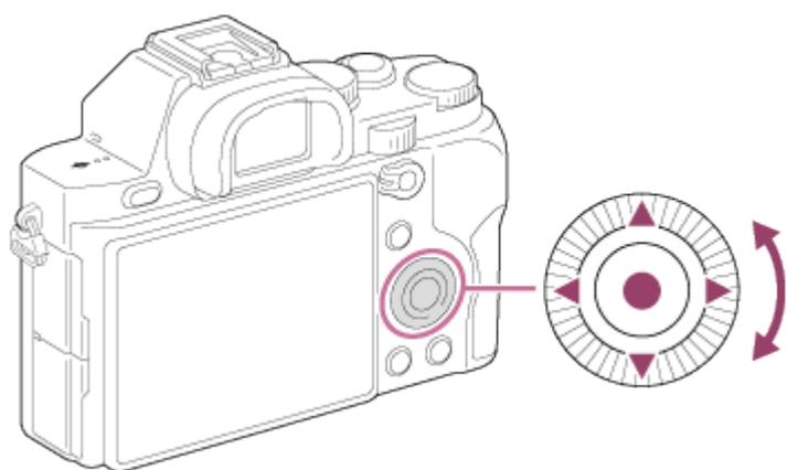
При повороте или нажатии на верхнюю/нижнюю/правую/левую сторону колесика управления, вы можете выбрать элементы установки. Ваш выбор будет принят при нажатии ● в центре колесика управления.
