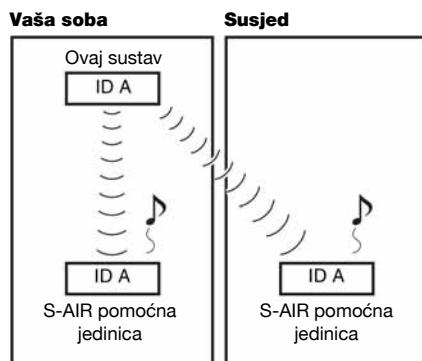
Nakon sparivanja se prijenos zvuka odvija samo između sparenog uređaja i S-AIR pomoćne jedinice (jedinica).
