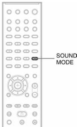
Pritisnite SOUND MODE više puta tijekom reprodukcije dok se na pokazivaču ne prikaže željeni mod
