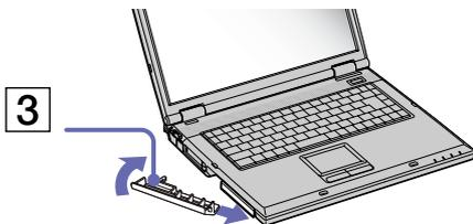
4 Fare scorrere la levetta di espulsione sulla base della protezione dello slot modulare verso il lato anteriore del computer, per bloccarla in posizione.
