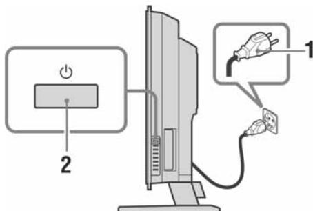
**1** Spojite TV prijemnik u mrežnu priključnicu (220 - 240 V AC, 50 Hz).
