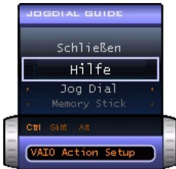
Das **Jog-Dial™**-Fenster schaltet in den Anleitungsmodus um, wenn Sie eine Anwendung starten und deren Fenster aktiv wird. Abhängig von der jeweiligen Anwendung werden im Jog Dial™-Fenster unterschiedliche Menübefehle angezeigt, die Sie durch Drehen oder Drücken des Jog Dial™ auswählen oder ausführen können.
