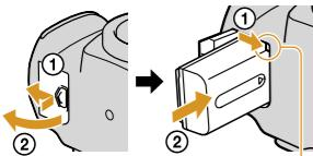
Zasuňte akumulátor na doraz, pričom jeho špičkou zároveň zatlačte na zaistovaciu pásku akumulátora.
