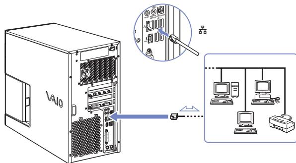
! Branchez exclusivement des câbles 10BASE-T/100BASE-TX/1000BASE-T sur le port Ethernet. L'utilisation d'autres câbles ou d'un cordon téléphonique risquerait de provoquer un dysfonctionnement, une surchauffe excessive ou même un incendie au niveau du port. Si vous utilisez cet ordinateur en Allemagne, veillez à ne pas faire usage d'un câble RNIS. Avec une tension supérieure à 12 V, il pourrait détruire la carte mère de votre ordinateur.
