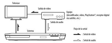
Seleccione uno de los siguientes métodos de conexión, de acuerdo con el tipo de toma del equipo.
