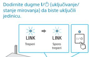
Indikator I/O (uključivanje/stanje mirovanja) će početi da svetli zelenom bojom. Pređite na sledeći korak kada indikator LINK počne da treperi sporo (jednom u 3 sekunde). Sporo treperenje počinje za oko 2 minuta.
