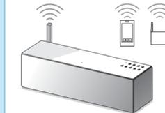
Povežite jedinicu i pametni telefon/iPhone uređaj na isti SSID rutera. Pogledajte sledeću stranicu gde se nalaze uputstva za povezivanje jedinice na Wi-Fi mrežu i proverite da li indikator LINK na jedinici svetli narandžastom bojom.
