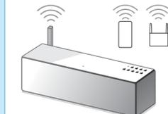
Povežite jedinicu i iPhone/iPad/iPod touch uređaj na isti SSID rutera. Pogledajte sledeću stranicu gde se nalaze uputstva za povezivanje jedinice na Wi-Fi mrežu i proverite da li indikator LINK na jedinici svetli narandžastom bojom.
