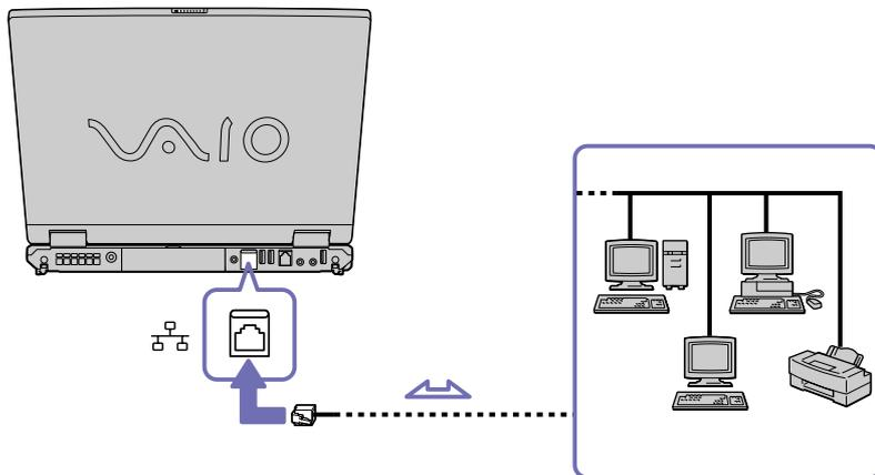
📌 Mit den Standardeinstellungen lässt sich der Computer an das Netzwerk anschließen.
