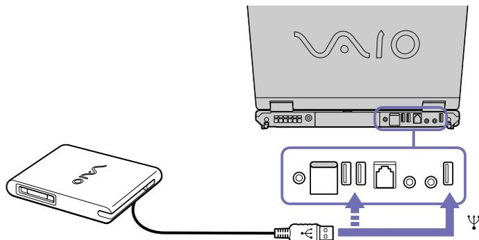
So entfernen Sie ein USB-Diskettenlaufwerk:
