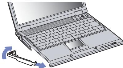
So entfernen Sie die Schachtabdeckung:
