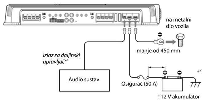
\*<sup>1</sup> Imate li tvornički ugrađeni ili neki drugi audio sustav bez izlaza za daljinski upravljač pojačala, povežite izlaz za daljinski upravljač (REMOTE) s pomoćnim izvorom napajanja. Kod spajanja ulaza visoke snage, audio sustav može raditi i bez spajanja REMOTE kontakta. Ipak, nije moguće jamčiti rad kod svih modela audio sustava.
