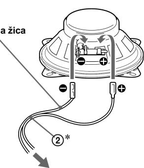
Na kabel za zvučnik u vozilu.
