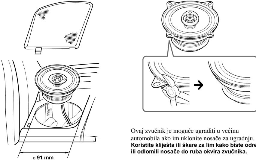
Ovaj zvučnik je moguće ugraditi u većinu automobila ako im uklonite nosače za ugradnju.
