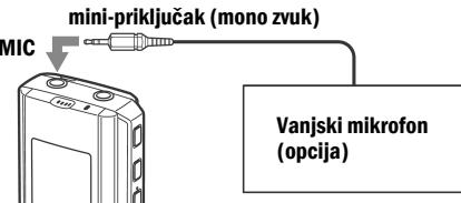
Prilikom spajanja vanjskog mikrofona, ugradeni mikrofon se automatski isključuje. Kada priključite **plug-in-power** mikrofon, on se automatski napaja iz izvora napajanja IC-rekordera.
