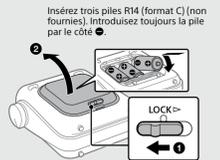
Pour maintenir les caractéristiques d'étanchéité, vérifiez que le couvercle du compartiment des piles est bien fermé et verrouillé. Pour des informations détaillées, voir « **Étanchéité (lire avant d'utiliser la radio)** ».
